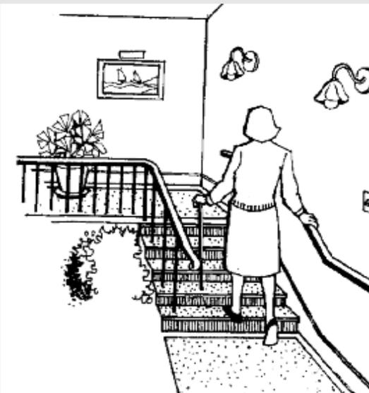
Pour la sécurité et la commodité des personnes ayant des troubles d'équilibre ou de la vue, l'escalier doit être bien éclairé, être muni de mains courantes bien solides se prolongeant au haut et au bas de l'escalier et présenter un net contraste de couleur ou de texture au bas et au haut.
